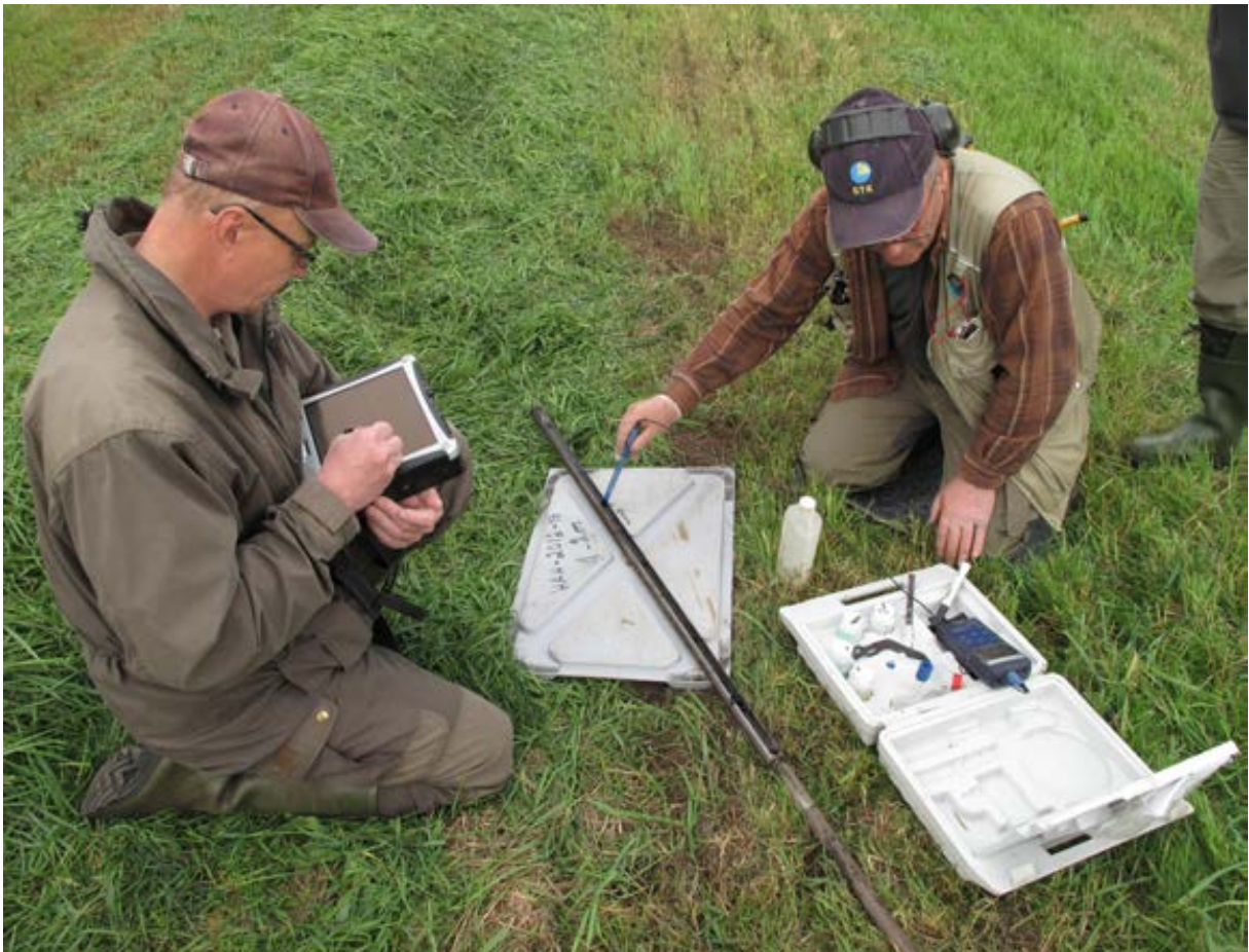
Kuva 7. Nykyaikaisessa maaperäkartoituksessa hyödynnetään maastotietokoneita havaintojen ja sijaintitiedon tallentamiseen. Kuvassa sulfaattimaiden kartoitusta Tervolassa käyttäen näytteenottokairaa ja kenttämittareita. Kuva P. Johansson.
