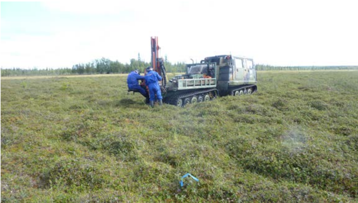
Kuva 14. Geokemiallista moreeninäytteenottoa GTK:n iskuporakalustolla Sodankylän pohjoisosassa. Kuva J. Valkama.
