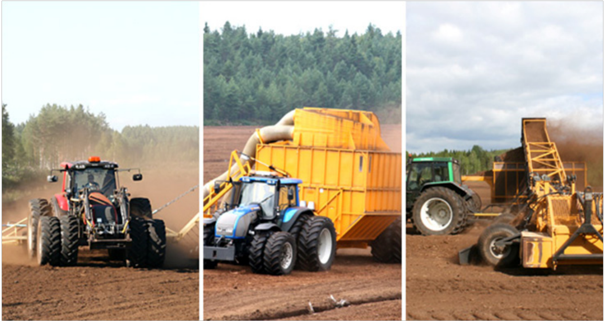
Kuva 3. Turpeennostoa erilaisilla menetelmillä hyödyntäen traktoria vetokoneena.
