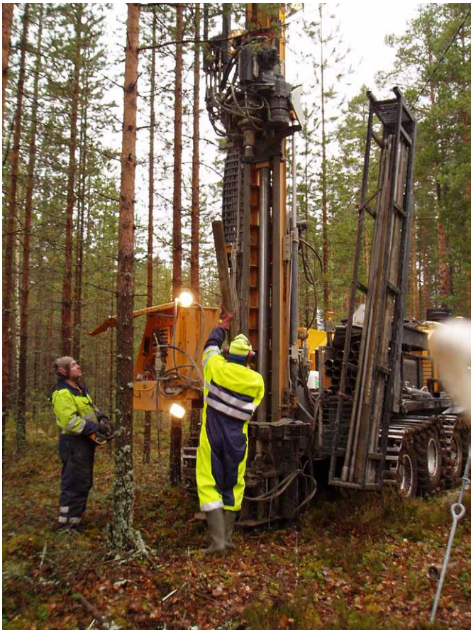
Kuva 3. Destian GM-200-kairakone työssä. Hankkeessa kairattiin yhteensä 1191,4 metriä ja otettiin 287 maaperänäytettä. Kuva Juho Kupila, GTK.
