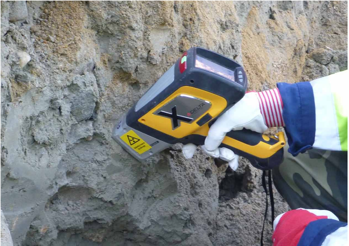
Kuva 2. Kannettavan XRF-analysaattorin käyttöä moreenin alkuainekoostumuksen selvittämisessä. Kuva P. Sarala.
