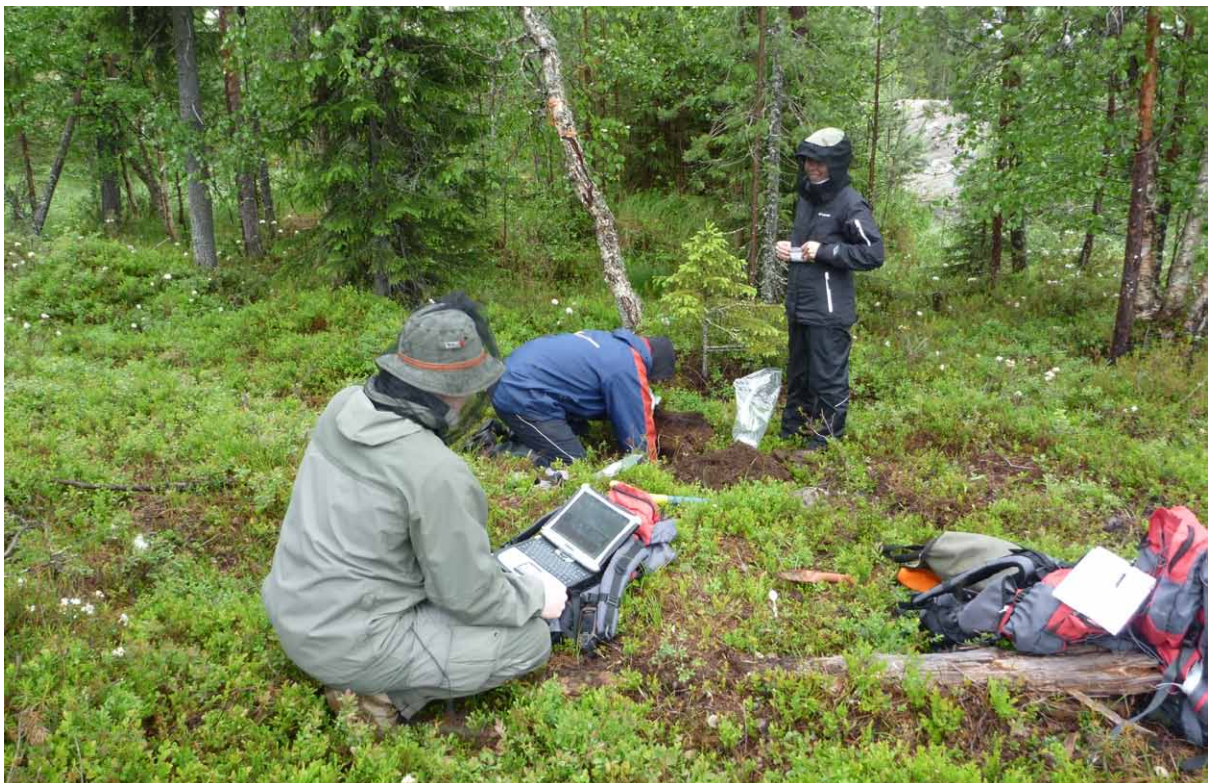
Kuva 3. Maan pintaosan mineraalimaanäytteiden keruuta heikkouuttomenetelmätestauksen näyttemateriaaliksi. Kuva P. Sarala.
