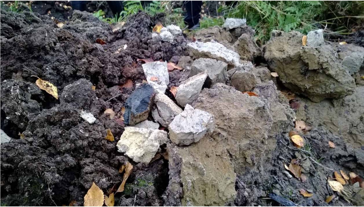
Kuva 2. Metsäojasta nostettua sulfidihiesua. Tuoreeltaan väri on usein mustaa, tummanharmaata tai harmaaraidallista (pH 6). Hapettuessaan sedimentin väri muuttuu vaaleanharmaaksi ja sen pH laskee (pH 3,5). Kuva Pauliina Liwata-Kenttälä.
