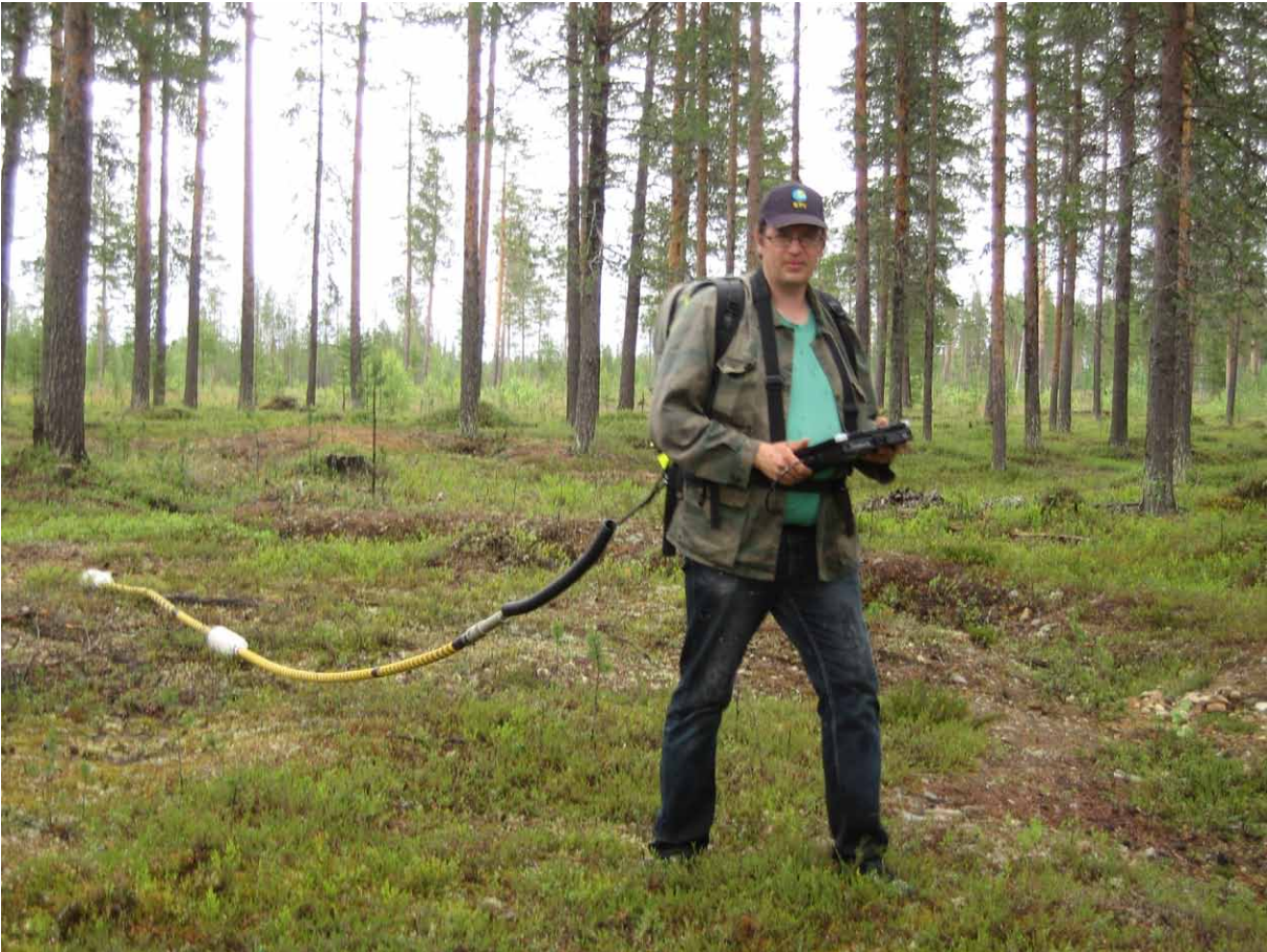
Kuva 2. Geologi luotaamassa maaperää letkutukalla. Kuva Jukka Räisänen, GTK.
