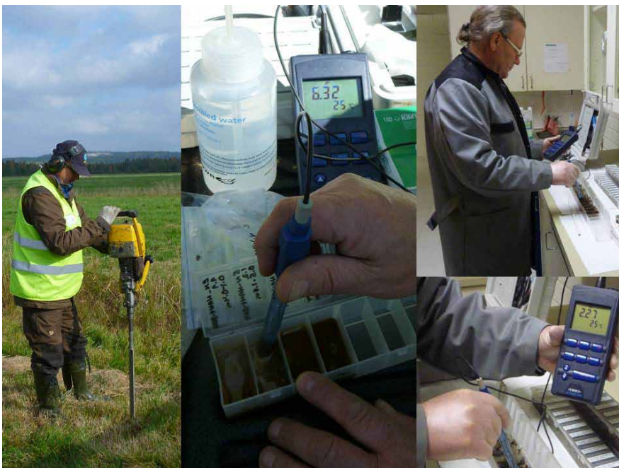
Kuva 5. Vasemmalla meneillään profiilipisteen kairaus. Keskellä pH:n mittausta maastossa näyteprofiista. Oikealla ylhäällä pH:n mittausta laboratoriossa, ja alhaalla alhainen pH:n arvo hapettamisjakson jälkeen. Kairauskuva Pentti Kouri, pH-maastokuva Pauliina Liwata-Kenttälä, labrapH-kuvat Hannu Hirvasniemi, GTK.
